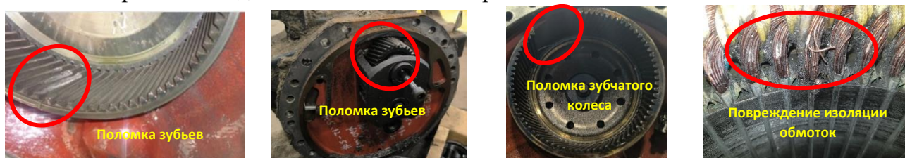
Рисунок 1 - Поломка элементов ЭМСП
