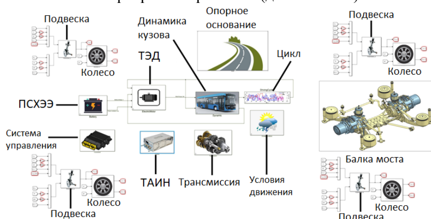
Рисунок 2 - Математическая модель движения колёсного ТС с ЭМСП
