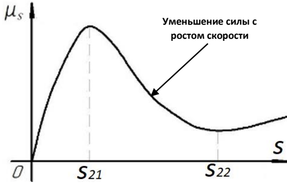
Рисунок 16 - Зависимость коэффициента сцепления от скольжения колеса
