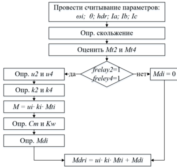
Рисунок 23 - Блок-схема алгоритма подавления колебаний
